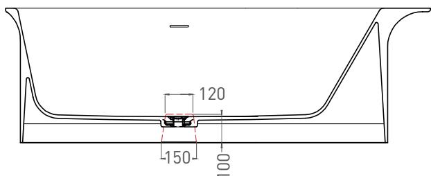
\* Расположение стандартного технического отверстия на задней стенке. В базовую комплектацию не входит, заказывается отдельно.
